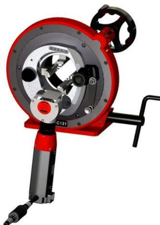
Je nach erforderlichem Qualitätsniveau kann auch ein Ausrichten der Fläche pro Bearbeitung der Werkzeugform (Maschine Typ DC) erfolgen, um einen perfekt glatten Oberflächenzustand des Abschnitts ohne Riefen sicherzustellen.
