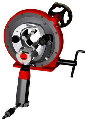
Selon le niveau de qualité exigé, il est également possible de réaliser un dressage de la face par travail de forme à l'outil (machine type DC) afin de garantir un état de surface de la section parfaitement lisse sans stries.
